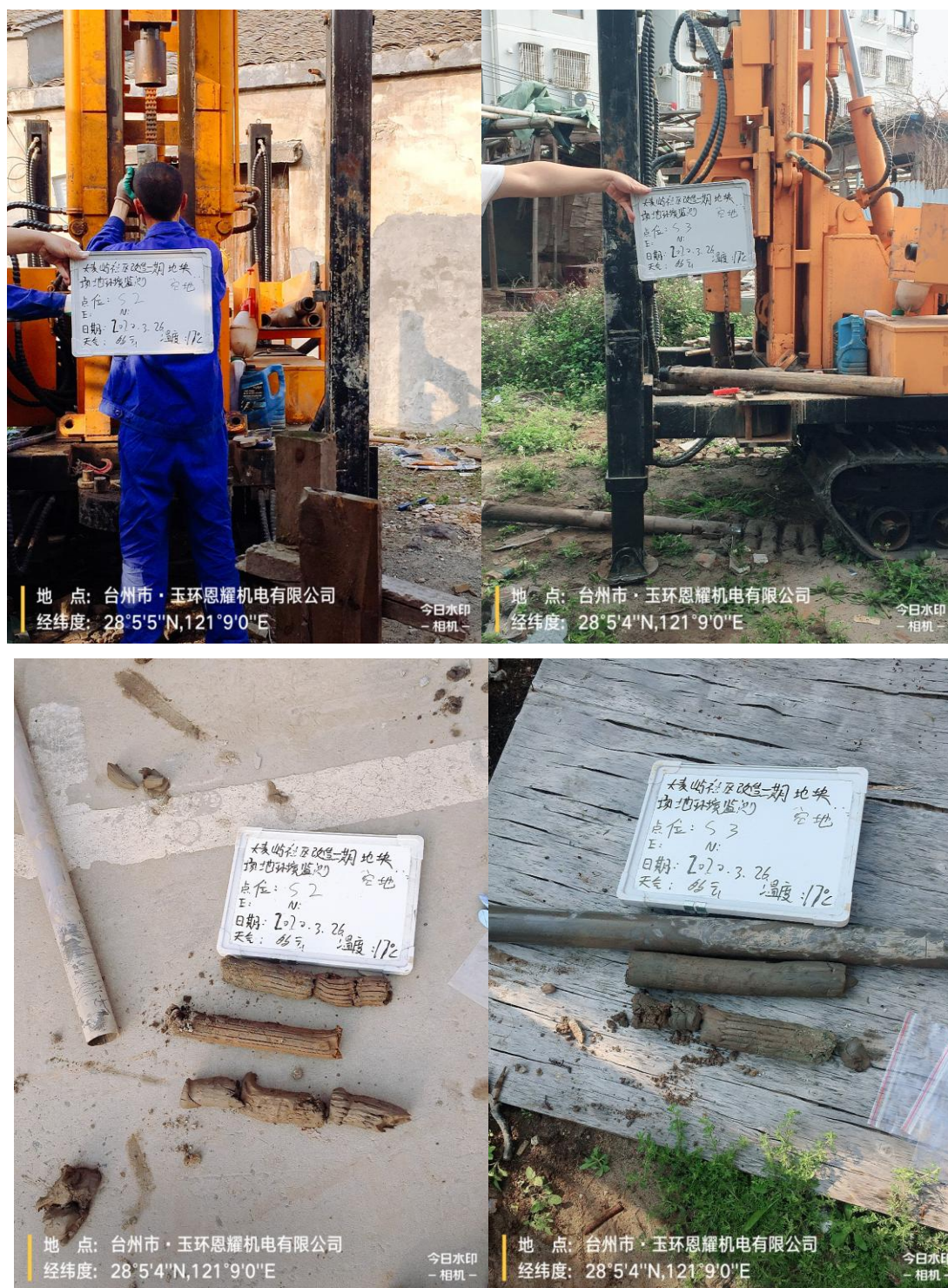
图 5-2 部分土壤钻孔及采样照片
