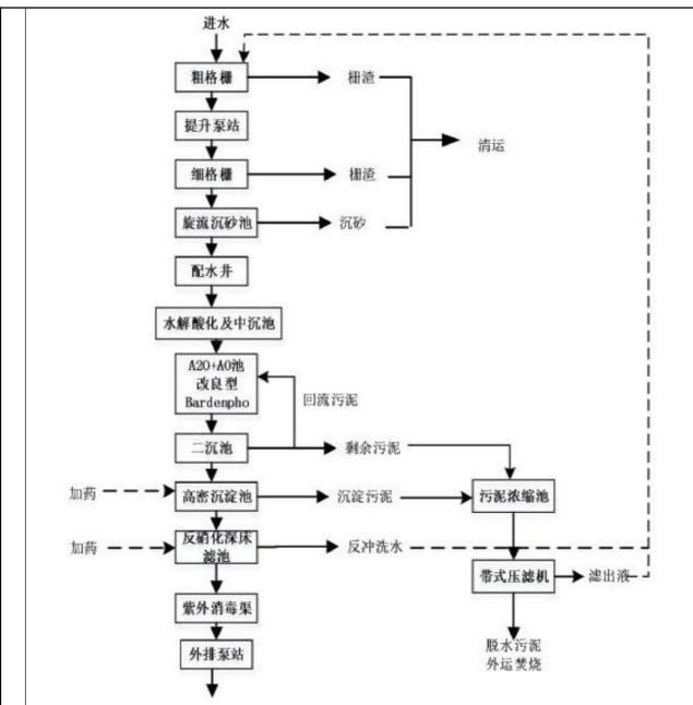
图 4-4 玉环市干江污水处理厂二期污水处理工艺流程图
